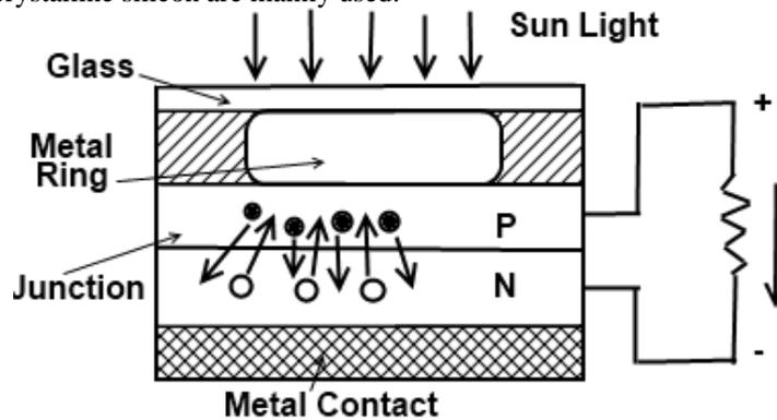
Fig. 1 PV Cells
